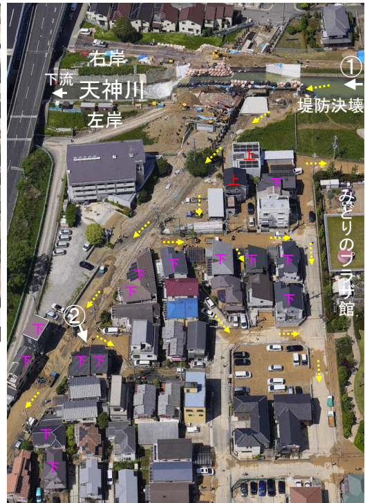
写真2 被災現場の空中写真(毎日新聞社提供) ①②は写真3の撮影地点。矢印は撮影方向、黄色の矢印は筆者らが現地調査と空中写真により推察した土砂流の流出方向。「上」は床上浸水, 「下」は床下浸水の被害)
