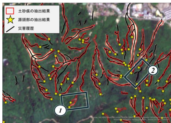
図-3 NDVI に基づく土砂流下痕の抽出結果の一例
